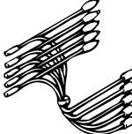
MB991658 | MB991658 | 测试线束 | 检查 A/C 压力传感器     |
