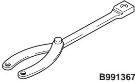
B991367   | MB991367 | 专用扳手 | 拆卸和安装空调压缩机电枢固定螺母 |
